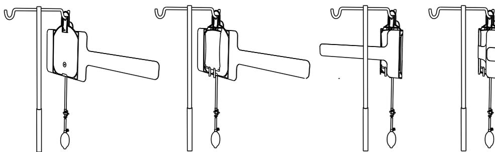
2- Rotamos la válvula a la posición de Inflado, comenzamos a inflar la misma hasta llegar a la presión deseada en el manómetro.
